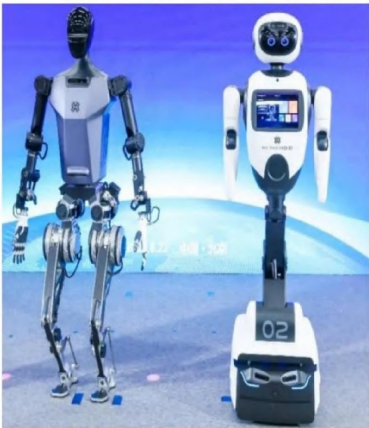
图：手部方案差异化：五指(左)、三指&夹爪(右) 图：下身方案差异化：双足(左)、轮式(右) 图：视觉方案差异化：纯视觉(左)、多传感器(右)
