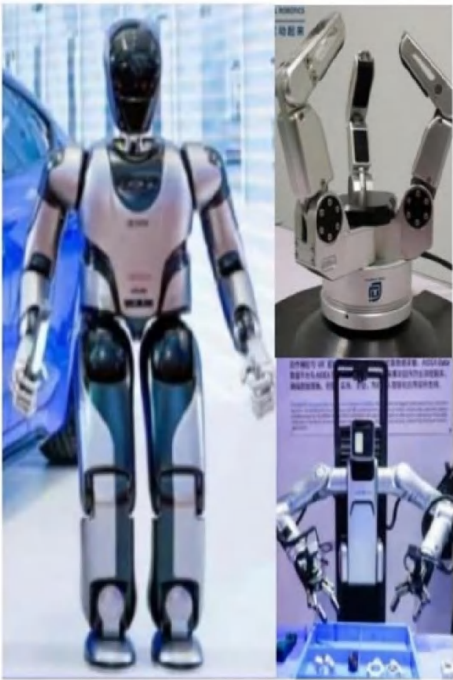
图：手部方案差异化：五指(左)、三指&夹爪(右) 图：下身方案差异化：双足(左)、轮式(右) 图：视觉方案差异化：纯视觉(左)、多传感器(右)
